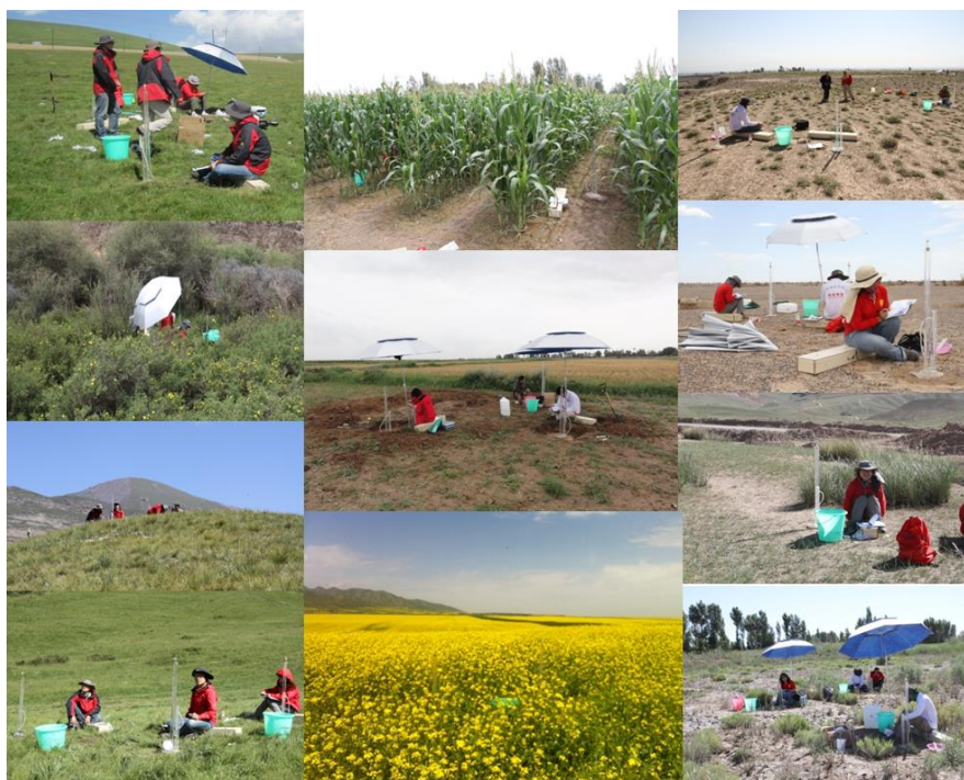
图 3-4 野外土壤饱和和导水率测定工作图
